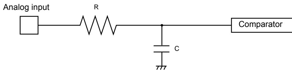
CY90V950AMAS     $4.5 \text{ V} \leq AV_{CC} \leq 5.5 \text{ V}$ :  $R := 2.52 \text{ k}\Omega$ ,  $C := 10.7 \text{ pF}$
