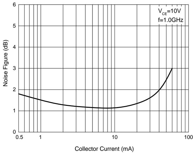
Fig. 4 -  $N_F$ - $V_{CE}$
