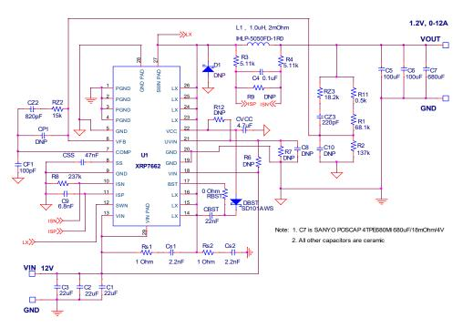
Fig. 17: 12V<sub>IN</sub> test circuit
